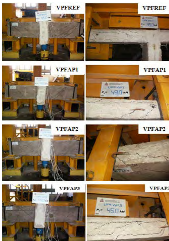
Figura 7: Camadas de concreto dos cojuntos preformados após a ruptura
